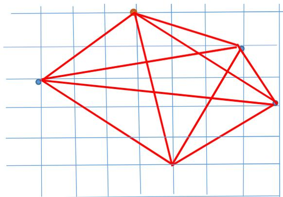
完全グラフ: 全ての点(頂点)の組み合わせが線(辺)で結ばれ図形(グラフ)のこと。
